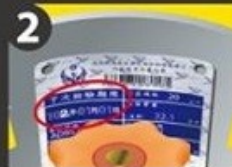
2 合格標示遭塗改、污損
